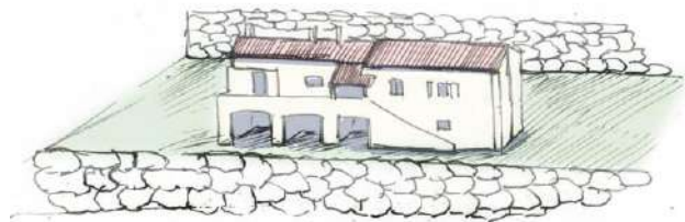
A éviter : soutènement et enrochements trop imposants
